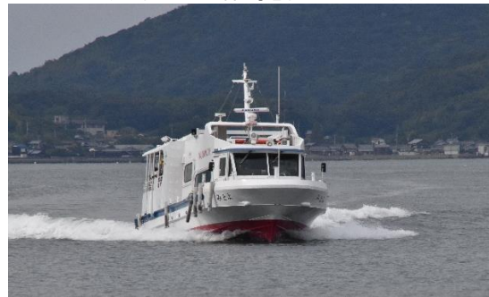
⑪ 多度津港から 30 分ほどで須田港に到着すると、ちょうど栗島からの新造の高速カーフェリー「みとよ」が入港してくるところでした。同船は船尾に小型車を 1 台積載できる 19 総トン型のカーフェリーです。
